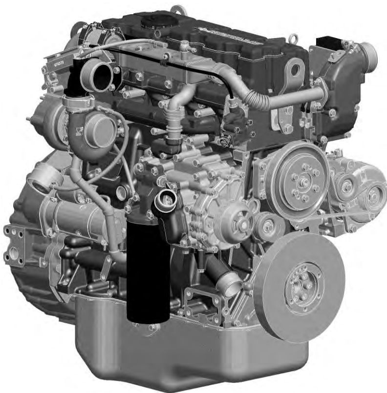
Рис. 16. Двигатель ЯМЗ-5341-10 – общий вид справа
